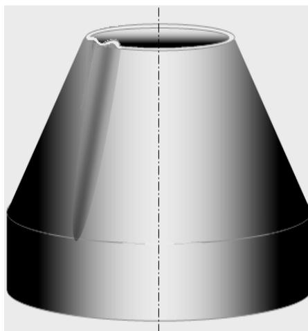
Рис. 1. Возникновение продольной складки в зоне деформации при обжиме тонкостенной трубчатой заготовки
